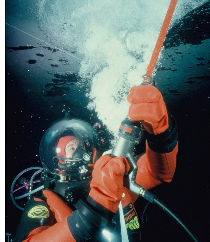
Philippe fait un trou dans la glace par en dessous avec un perforateur/marteau-piqueur pneumatique sous-marin. © F. Le Guen
